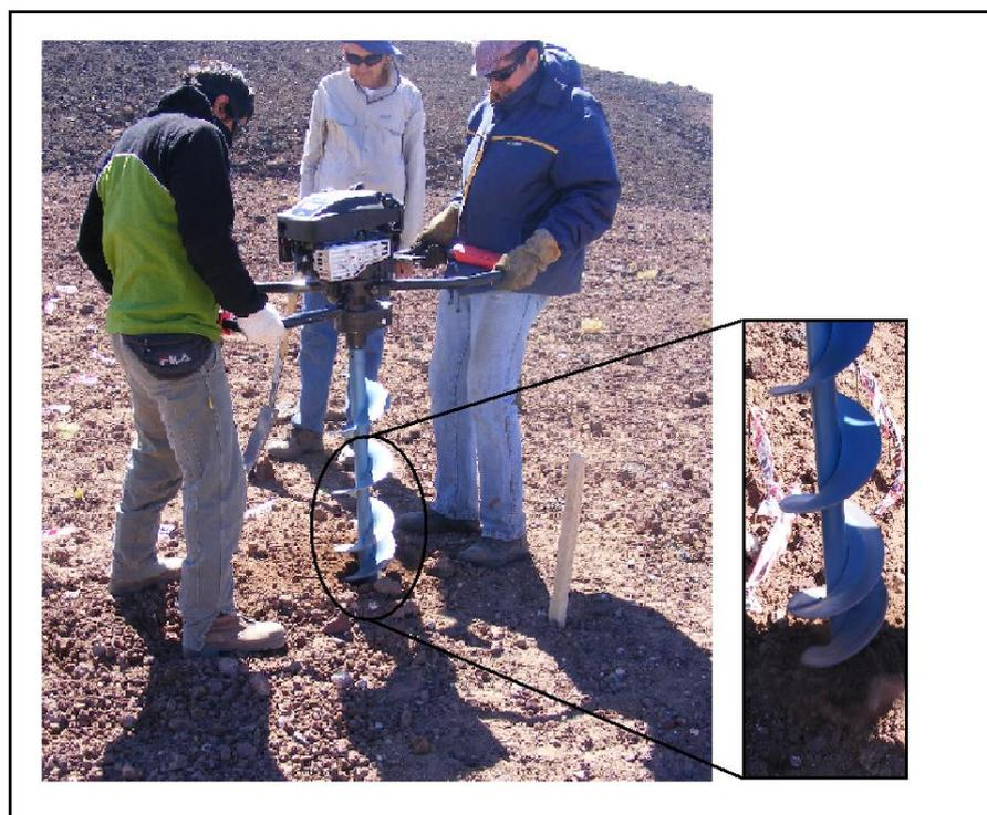
**Figura 12:** Operarios realizando el ahoyado, a la derecha se muestra un detalle de la mecha utilizada.
