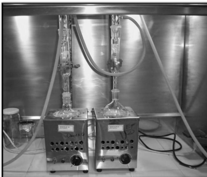
Figura 2. Extracción Soxhlet de muestras de suelo.
