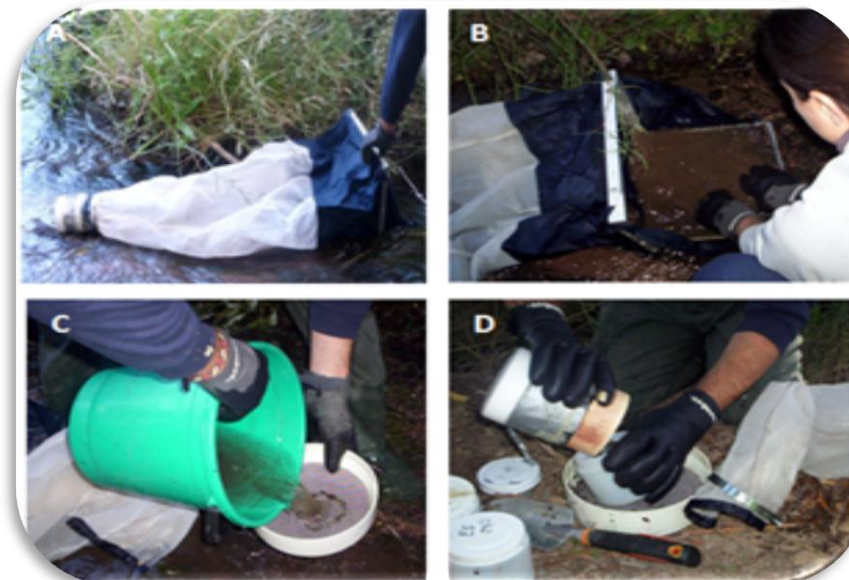
Figura 10. A) Posicionando red Surber. B) Muestreo y colecta con red Surber. C) Tamizado de la muestra. D) Colocación en recipiente para almacenaje.
