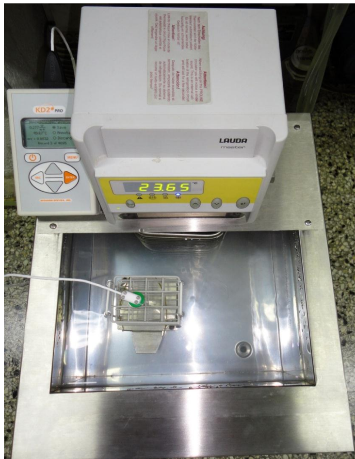
Figura 3.7 Sistema de medición de conductividad térmica.
