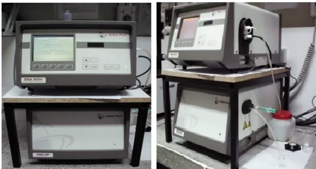
Figura 3.5 Analizador de densidad y período de oscilación DMA-HP, conectado a un analizador Anton Paar DSA-5000.
