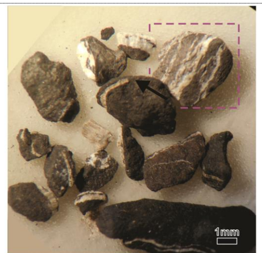
Figura 4.39: Microvenillas de calcita pertenecientes al pozo BAñ-VMI, particularmente en la zona productora del mismo (2624 mbbp). La flecha negra indica la discontinuidad lateral en la microvenilla y el cuadro púrpura señala marga con textura brechosa.
