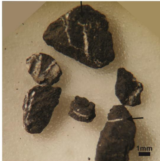
Figura 4.41: Microvenillas de calcita pertenecientes al pozo BAñ-VM1, particularmente en la zona productora del mismo (2626 mbbp). Las flechas negras indican la discontinuidad lateral en las microvenillas.
