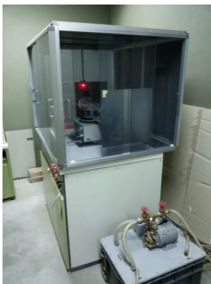
Figura 3.3: Difractómetro de rayos X Rigaku D-Max IIC.
