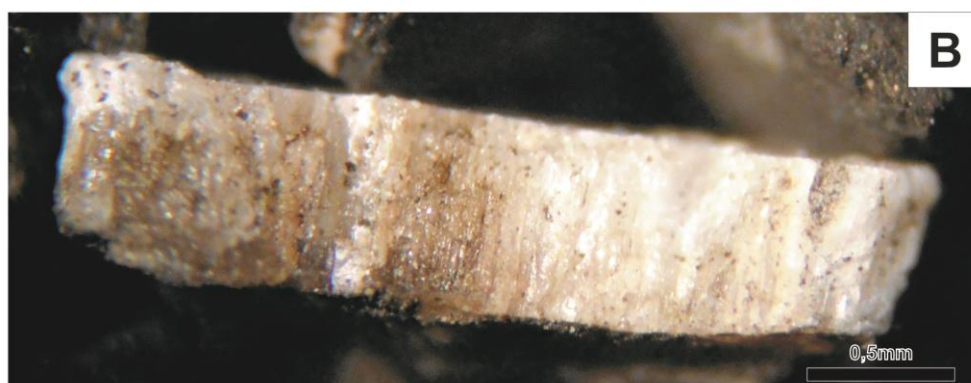
Figura 4.47: Microvenillas de calcita pertenecientes al pozo BAñ-VM3, en las profundidades de 2754 mbbp (A) y 2778 mbbp (B)
