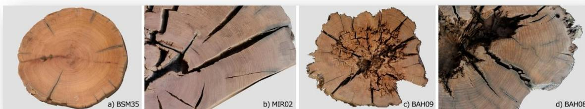
Figura 3. a) Sección transversal (ST) con radios completos b) ST partida con radio completo c) ST en mal estado d) ST con radios muy cortos de pocos anillos para lograr un fechado preciso.
