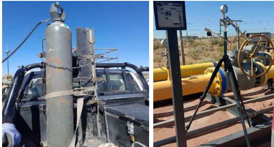
Figura N°17: Tanque contenedor de refrigerante e instrumento de medición Bureau of Mines.
