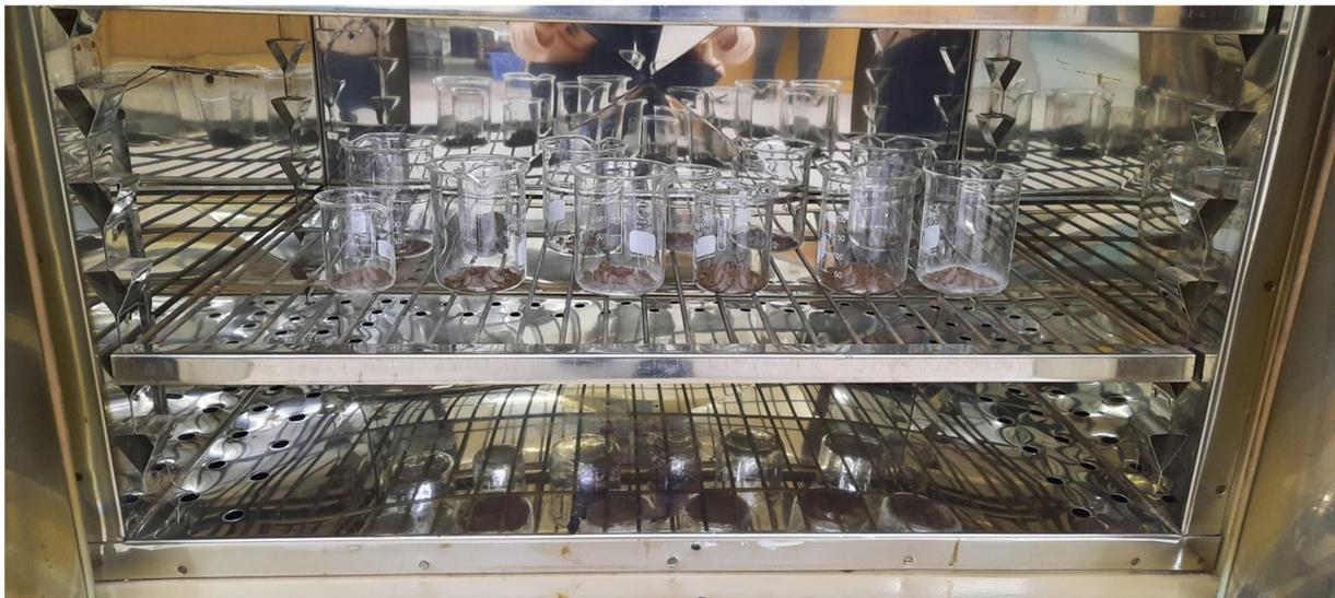
Figura 2.17 Secado de suelo en estufa para determinación de humedad gravimétrica
