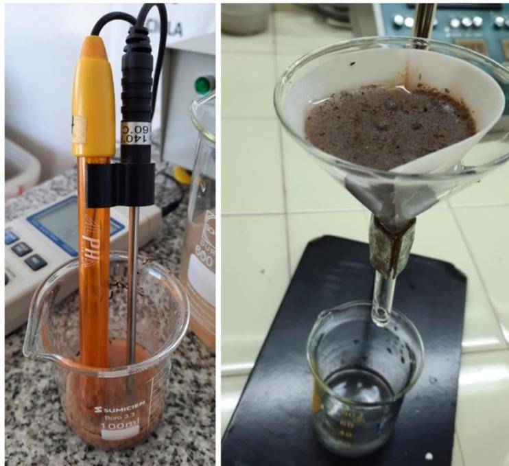
Figura 2.10 (izquierda). Medición de pH sobre suspensión de suelo. Figura 2.11 (derecha). Ensayo para determinación de capacidad de campo.
