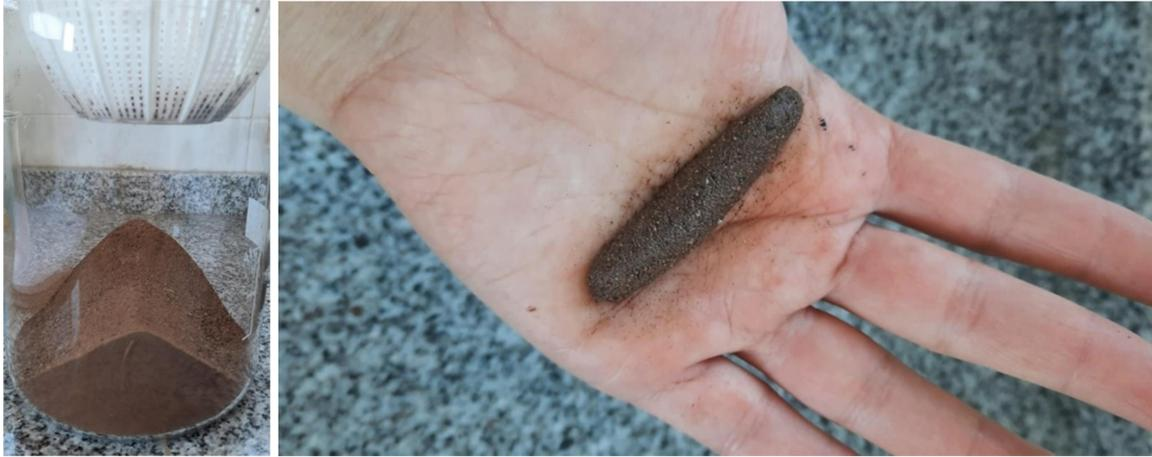
Figura 2.7 (izquierda): Tamización del suelo; Figura 2.8 (derecha): Determinación de la clase textural del suelo por método del tacto
