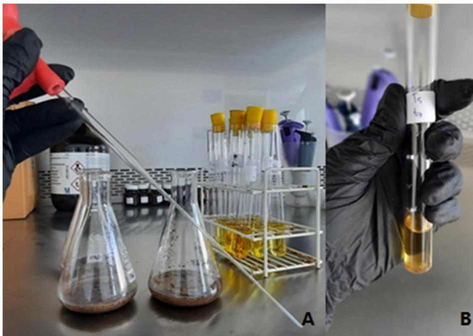
Figura 2.18 A y B Preparación de extractos para determinación de HTP
