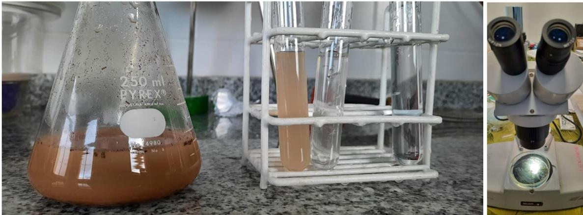
Figura 2.12 (izquierda). Preparación de suspensión de suelo. Figura 2.13 (derecha). Recuento en placa con lupa.
