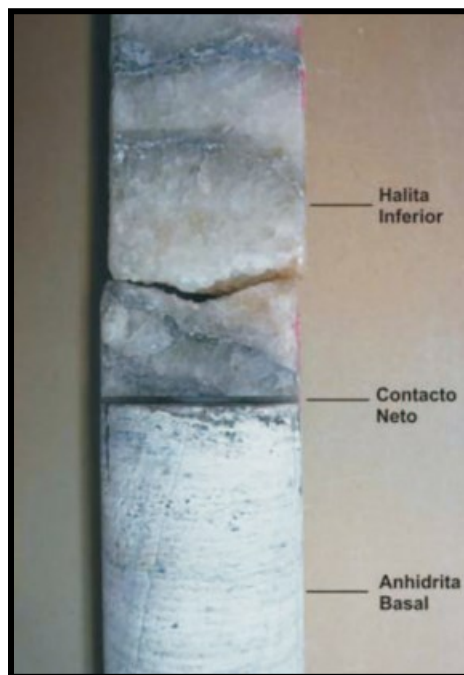
Figura 22. Contacto neto entre los Sulfatos Basales (Anhidrita Basal) y la Halita Inferior (Gómez Figueroa et al. , 2011).
