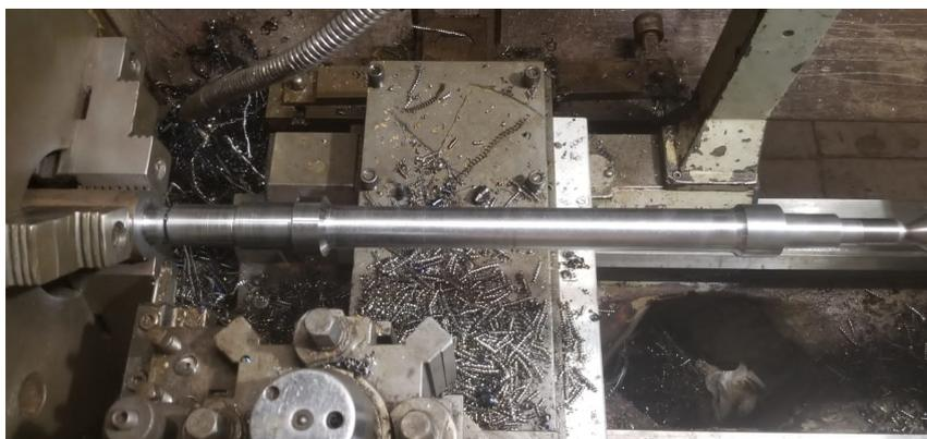
Figura 39. Mecanizado del eje.
