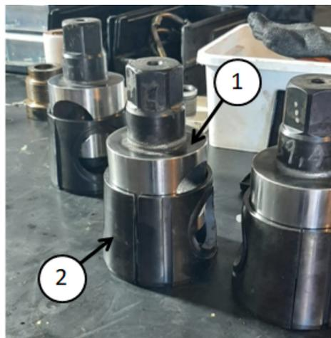
Figura 2. Detalle componentes interiores de una Válvula tapón.
