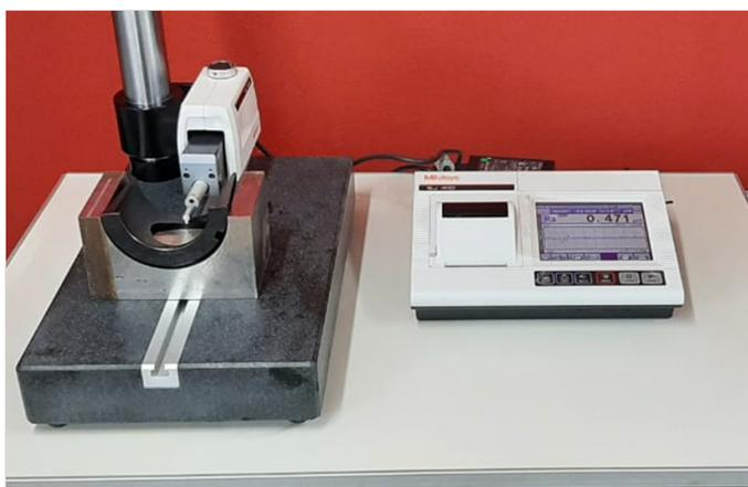
Figura 49. Control de rugosidad de un segmento.
