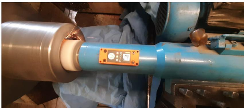
Figura 46. Medición de vibraciones.
