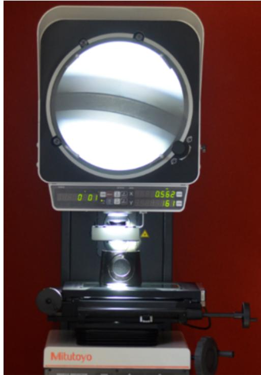
Figura 50. Medición de curvatura segmentos rectificadas con un proyector de perfiles.
