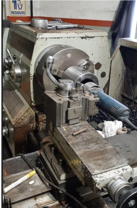
Figura 21. Pruebas preliminares con un prototipo físico basado en una amoladora recta.
