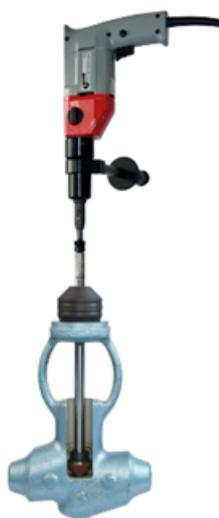
Figura 56. Rectificadora Modelo VSK ([www.efco-dueren.de](http://www.efco-dueren.de)).
