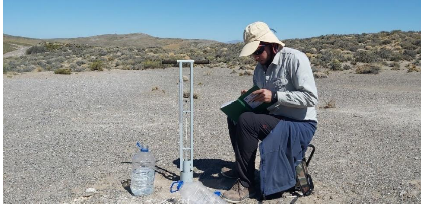
Figura 13: Ensayo de infiltración con infiltrómetro de doble anillo.
