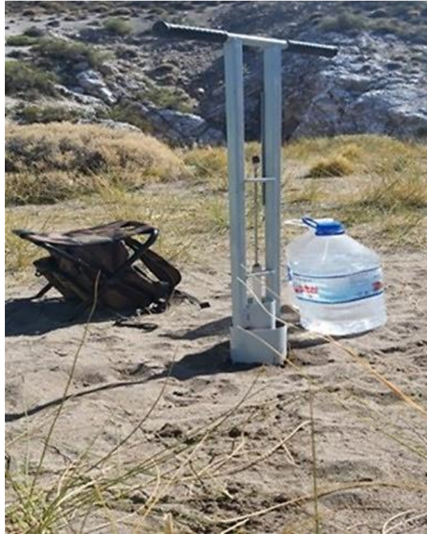
Figura 16: Imagen del sitio 3, con ensayo realizado sobre sedimentos muy finos y escasa cobertura vegetal. Atrás se observa la boca de la cueva, que corresponde al inicio de la dolina de colapso.
