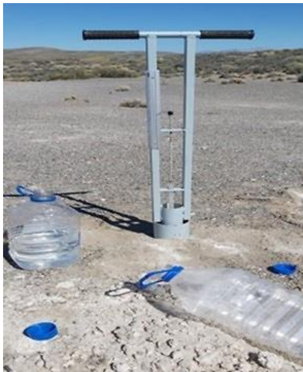
Figura 18: Imagen del sitio 5 donde se observa ausencia de vegetación, sedimentos muy finos y una muy alta capacidad de infiltración.
