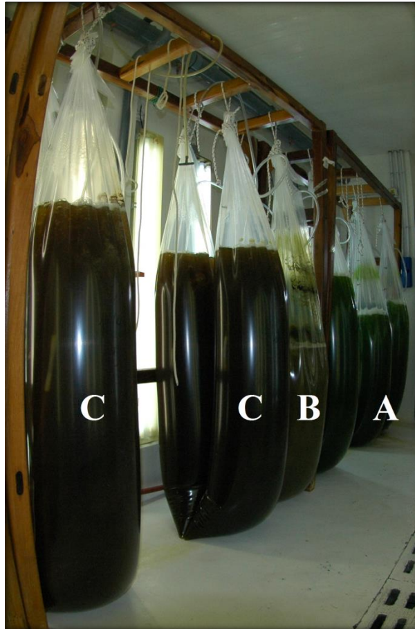
Figura 9. Cultivo masivo de 140 l. A: Tetraselmis suecica , B: Isochrysis galbana , C: Chaetoceros sp.
