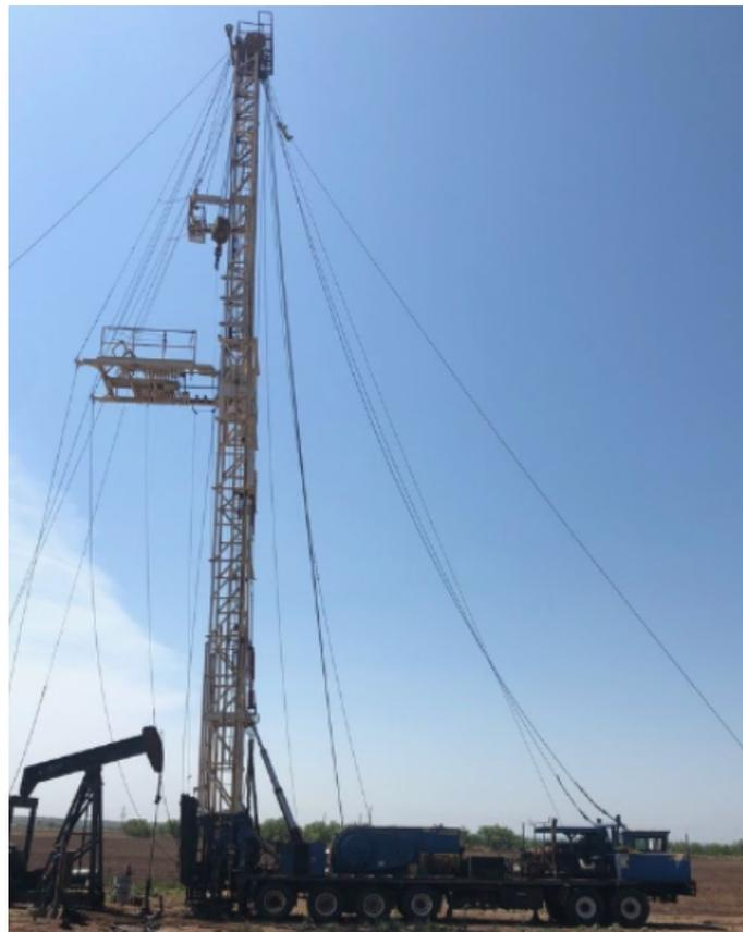
Figura 5. Equipo de *pulling* en operación.
