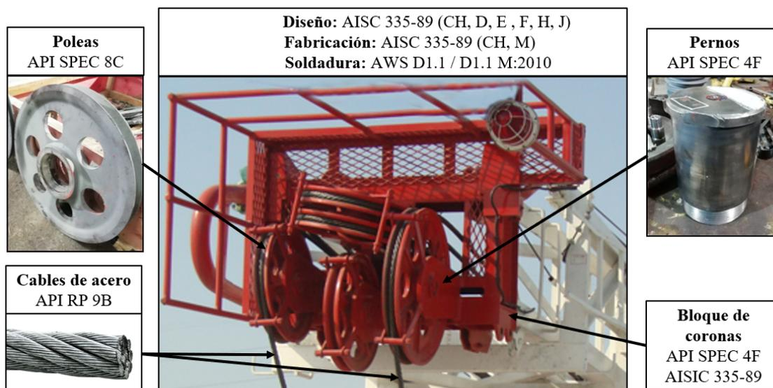
Figura 8. Normativa de aplicación para el diseño y fabricación de los componentes principales del sistema de izaje.
