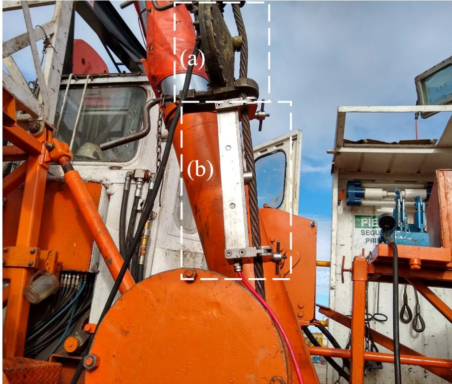
Figura 4. Detalle de instalación del sistema de medición de cargas en la línea muerta.
