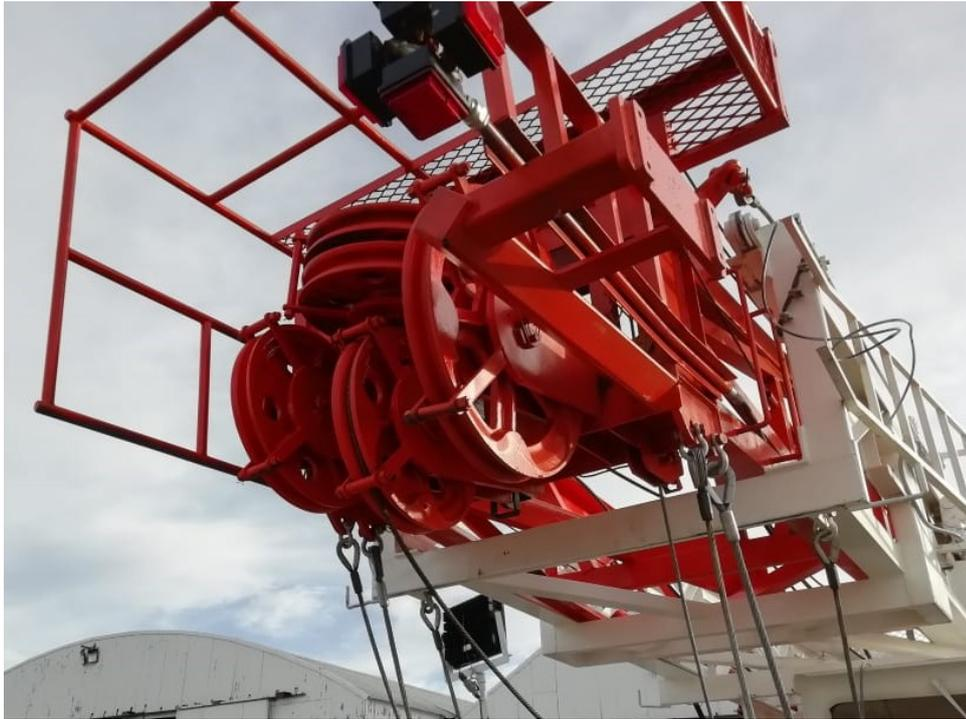
Figura 2. Sistema de coronas de un equipo de *pulling*.
