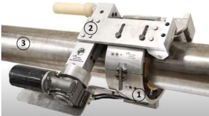
(a) Cabezal con sensores magnéticos (1), *Buggy* (2) y Barra a inspeccionar (3).
