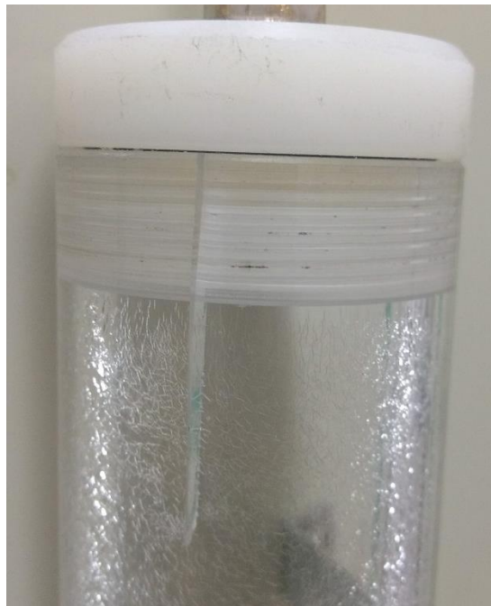
Figura 4.2.4: Fractura vertical en la rosca de un tanque de almacenamiento.
