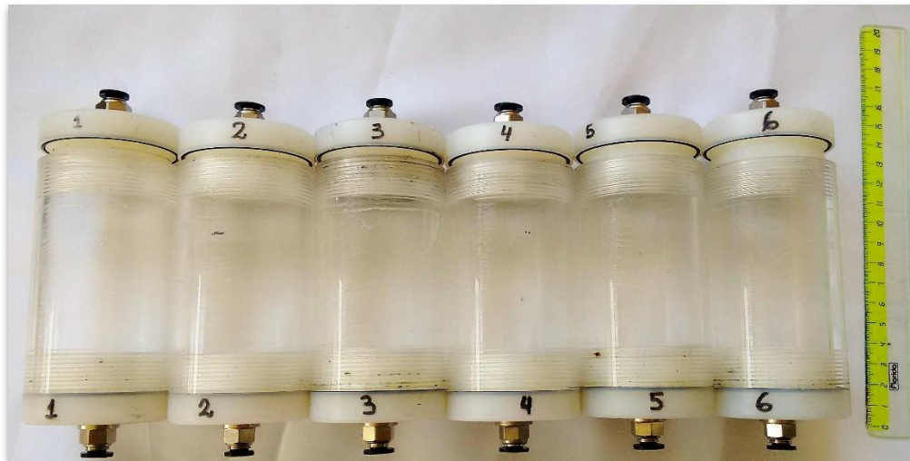
Figura:3.3.2: Celdas y conectores.
