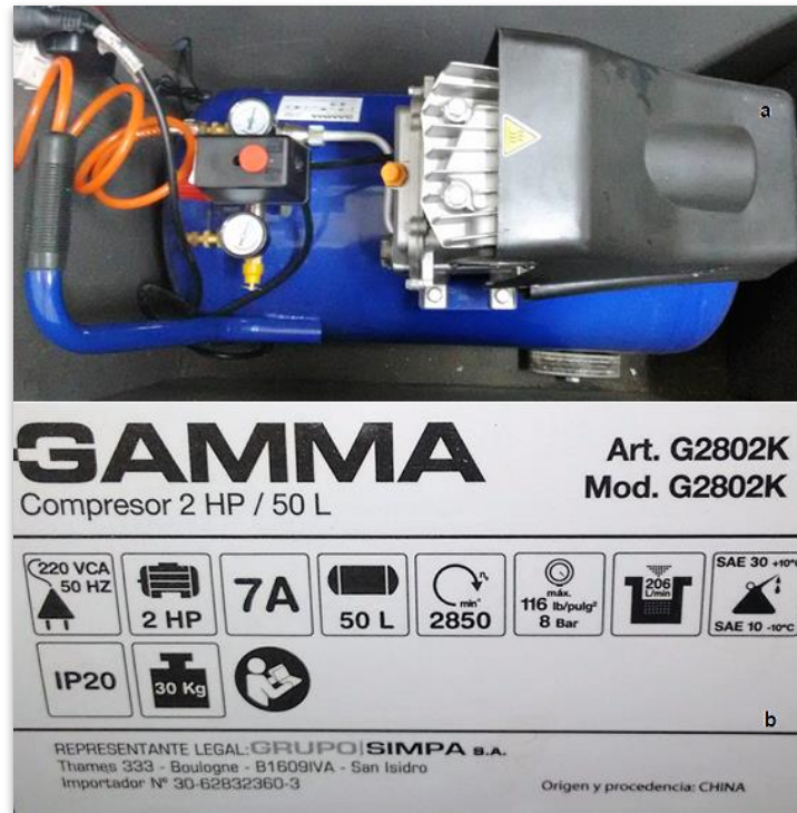
Figura 3.2.2: a) Compresor. b) Características del compresor.
