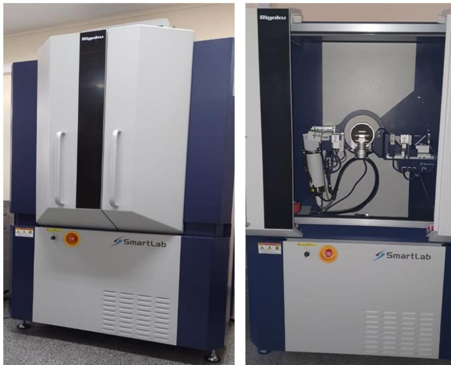
Figura 11: Equipo de difracción de rayos X modelo SmartLab SE marca Rigaku.
