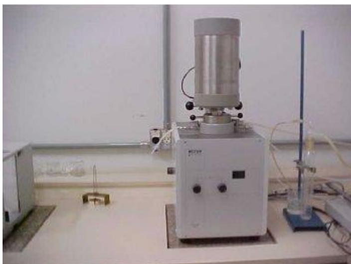
Figura 12: Equipo ATD-TG NETZCH STA 409 CELL EQ 23
