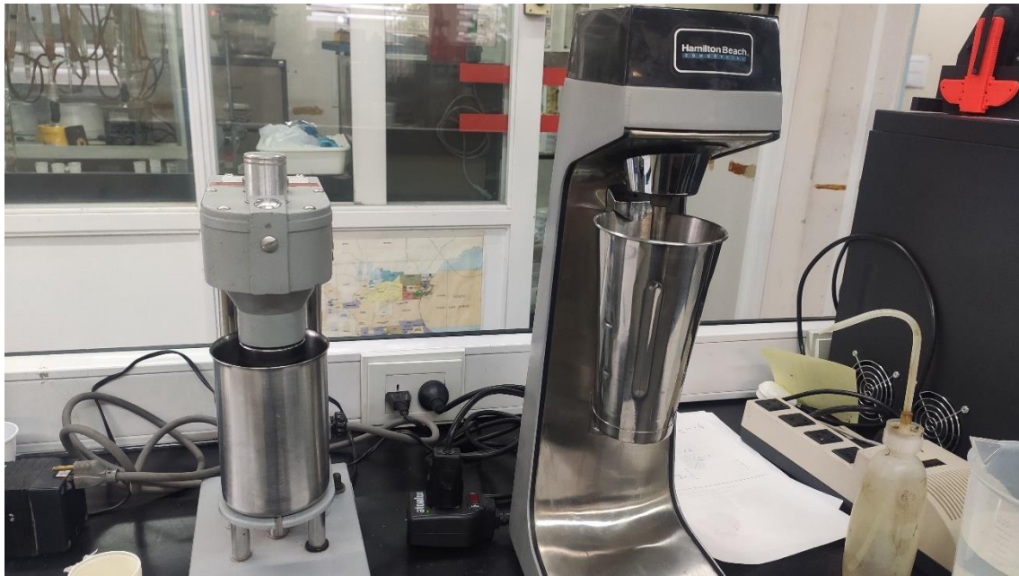
Figura 3.20: equipos usados para la preparación de la mezcla y mediciones reológicas: viscosímetro Fann (izq.), mezcladora Hamilton Beach (der).
