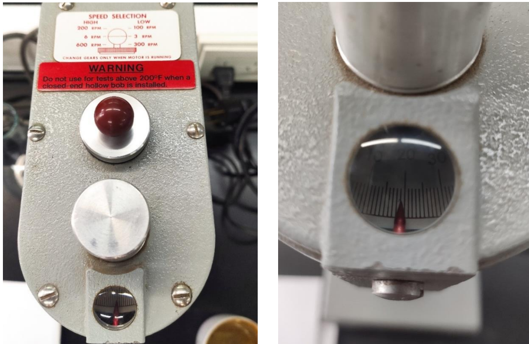
Figura 3.22: selector de velocidad (izq.) y lectura del viscosímetro Fann (der.).
