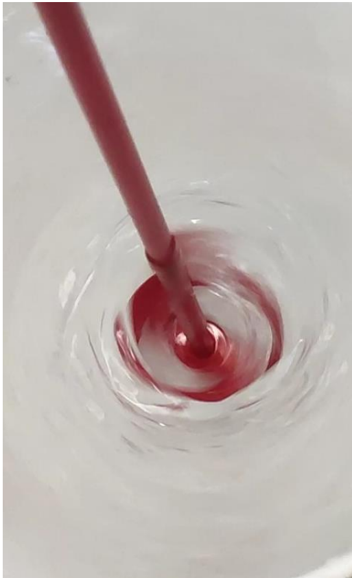
Figura 3.25: vórtice al momento de agregar el polímero.
