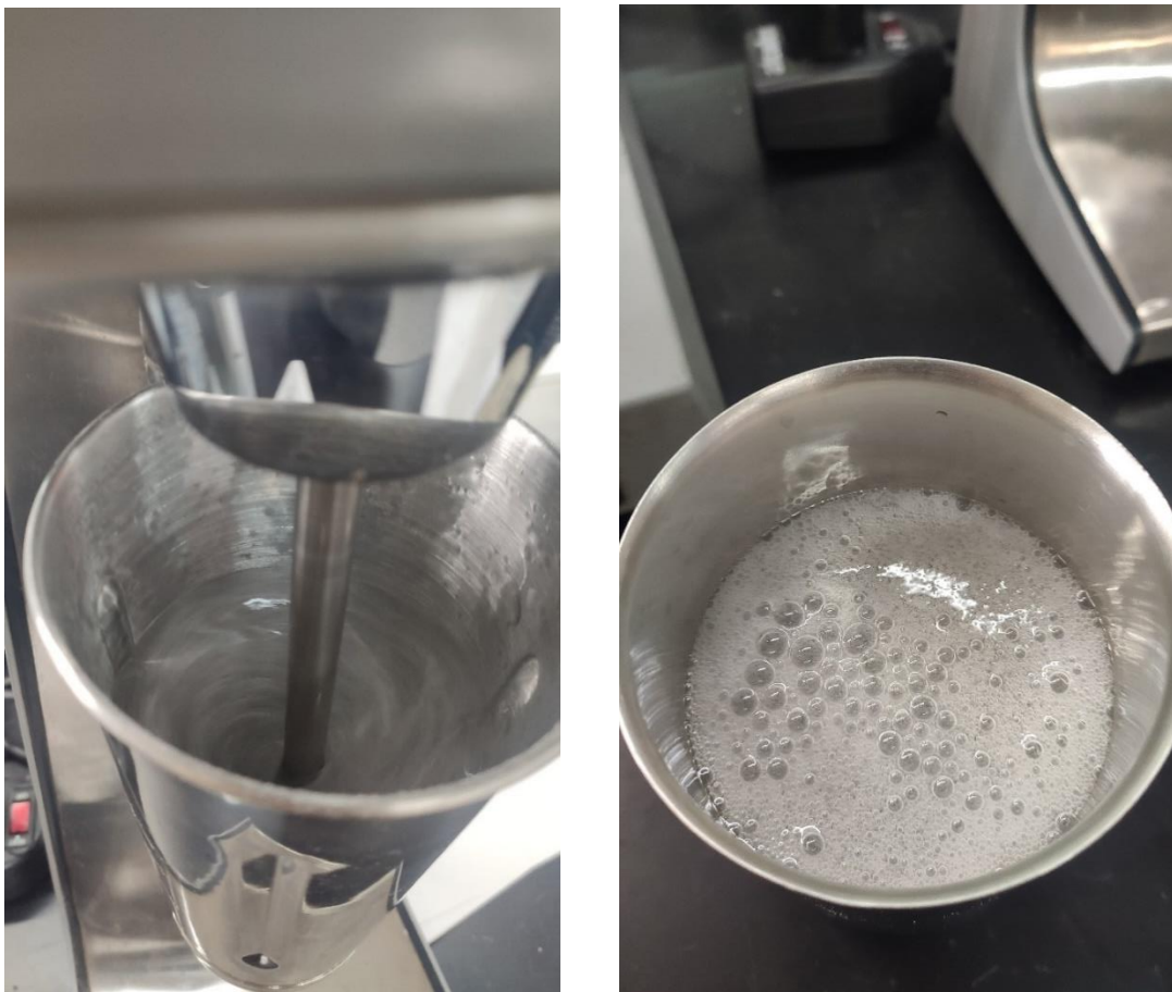
Figura 3.21: proceso de mezclado agua-polímero: mezcla en preparación(izq.), mezcla preparada (der.).
