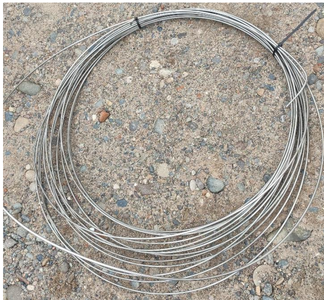
Figura 3.4: tubería flexible de acero inoxidable.
