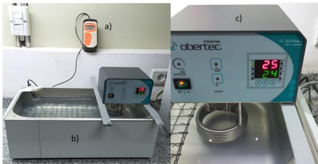
Figura 3.3. a) Termómetro b) Termostato c) Termo controlador modelo TC- 800 M marca Obertec. Fuente: Imagen propia.
