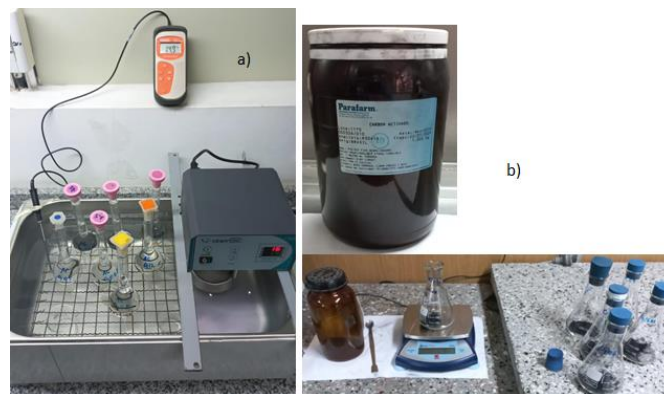
Figura 3.9. a) Disoluciones termostatizadas b) Pesada de carbón activado. Fuente: Imagen propia
