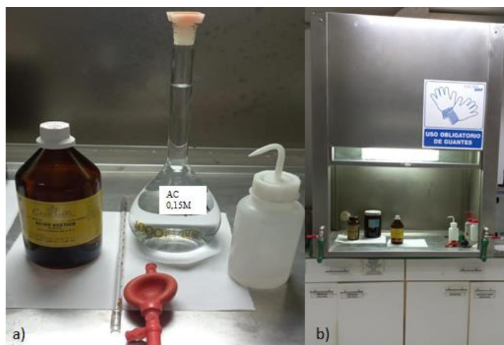
Figura 3.6. a) Solución de ácido acético aproximadamente 0,15 M b) Campana de extracción. Fuente: Imagen propia
