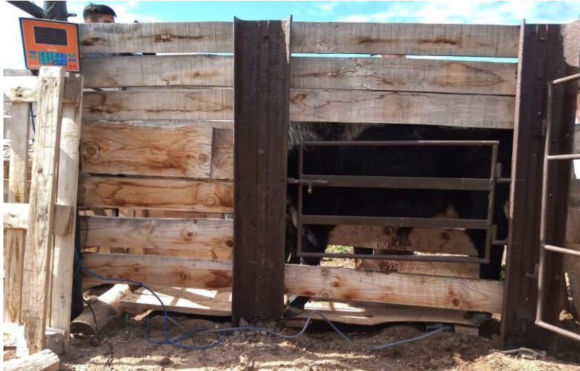
Figura nº3: Balanza digital adaptada a la manga.
