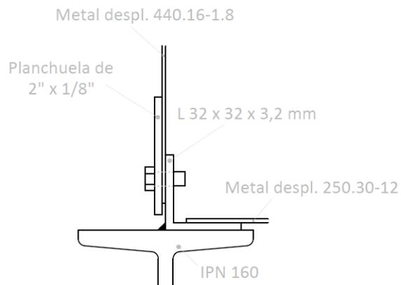
Figura A5.1: Detalle de la unión entre el cerramiento lateral y el tablero de circulación.
