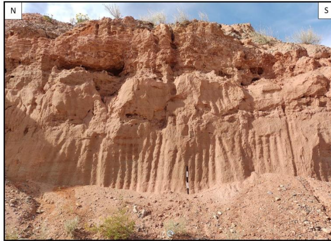
Figura 29. La secuencia está muy poco diagenizada y los términos arenosos son friables, permitiendo la explotación mediante pala mecánica (Hoja Geológica 3969 -II)
