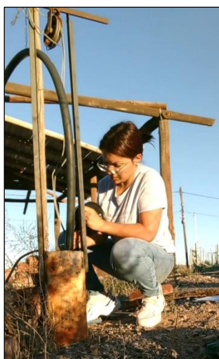
Figura 50. Medición de nivel piezométrico en perforación mediante sonda freaticométrica
