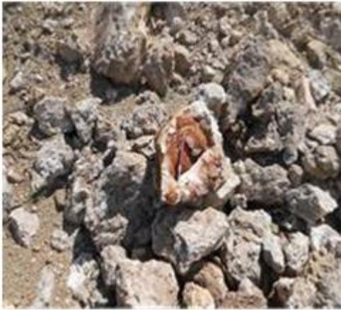
**Figura 45:** Texturas mamelonares y botroidales de  $\text{BaSO}_4 + \text{SrSO}_4$ , pertenecientes a la mina Barda.
