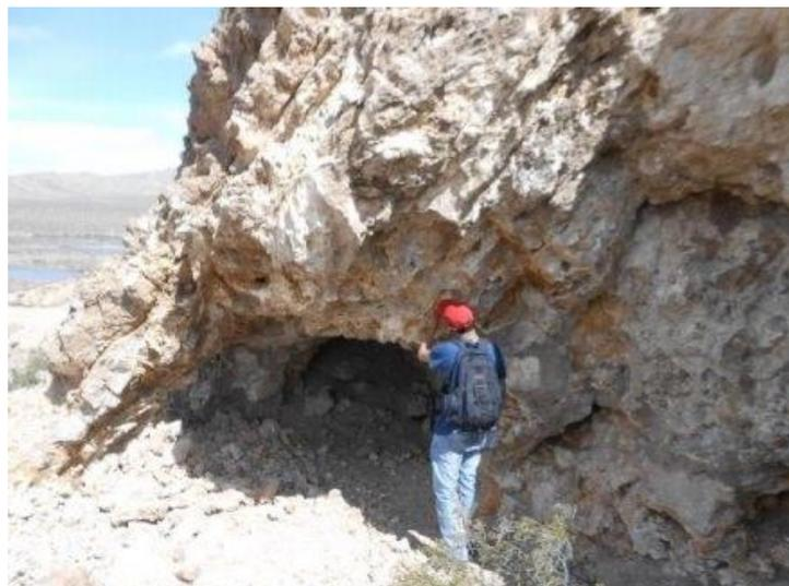
**Figura 44:** Barda Klein. Manto buzante: Explotación a cielo abierto en sectores superficiales. Mina con evidencias de disolución kárstica.
