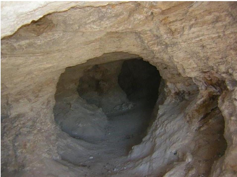
**Figura 42:** Manto de posición subhorizontal. Estructura homoclinal. Explotación mediante cámaras y pilares. Nótese la uniformidad del banco mineralizado. Mina Cecilia, Distrito Continental.
