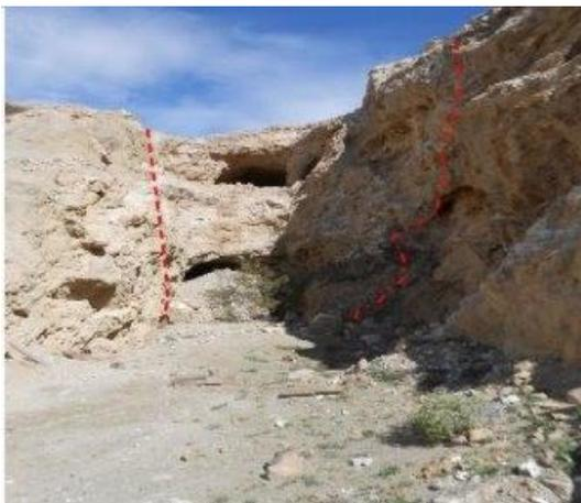
**Figura 11:** Vista hacia el sur, socavones sobre manto y exploración a cielo abierto. La línea de color rojo marca la tendencia bolsonar de la mineralización mantiforme.
