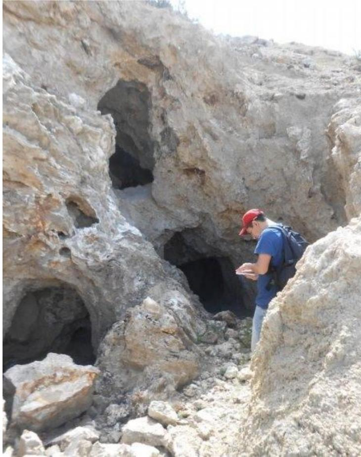
**Figura 43:** Explotación mediante socavones en afloramientos superficiales, mina Barda Klein. Mineralización de baritocelastina recristalizada por disolución kárstica.
