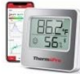
Ilustración 22. Medidor fijo TP 357 Thermo Pro de TEMPERATURA Y HRA con monitoreo remoto a través del SmartPhone vía bluetooth, alcance Bluetooth de hasta 80 metros.
