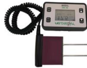
Ilustración 20. Medidor portátil de humedad del sustrato TDR-150, enterrando las puntas se toma una muestra y mide la disponibilidad de agua.
