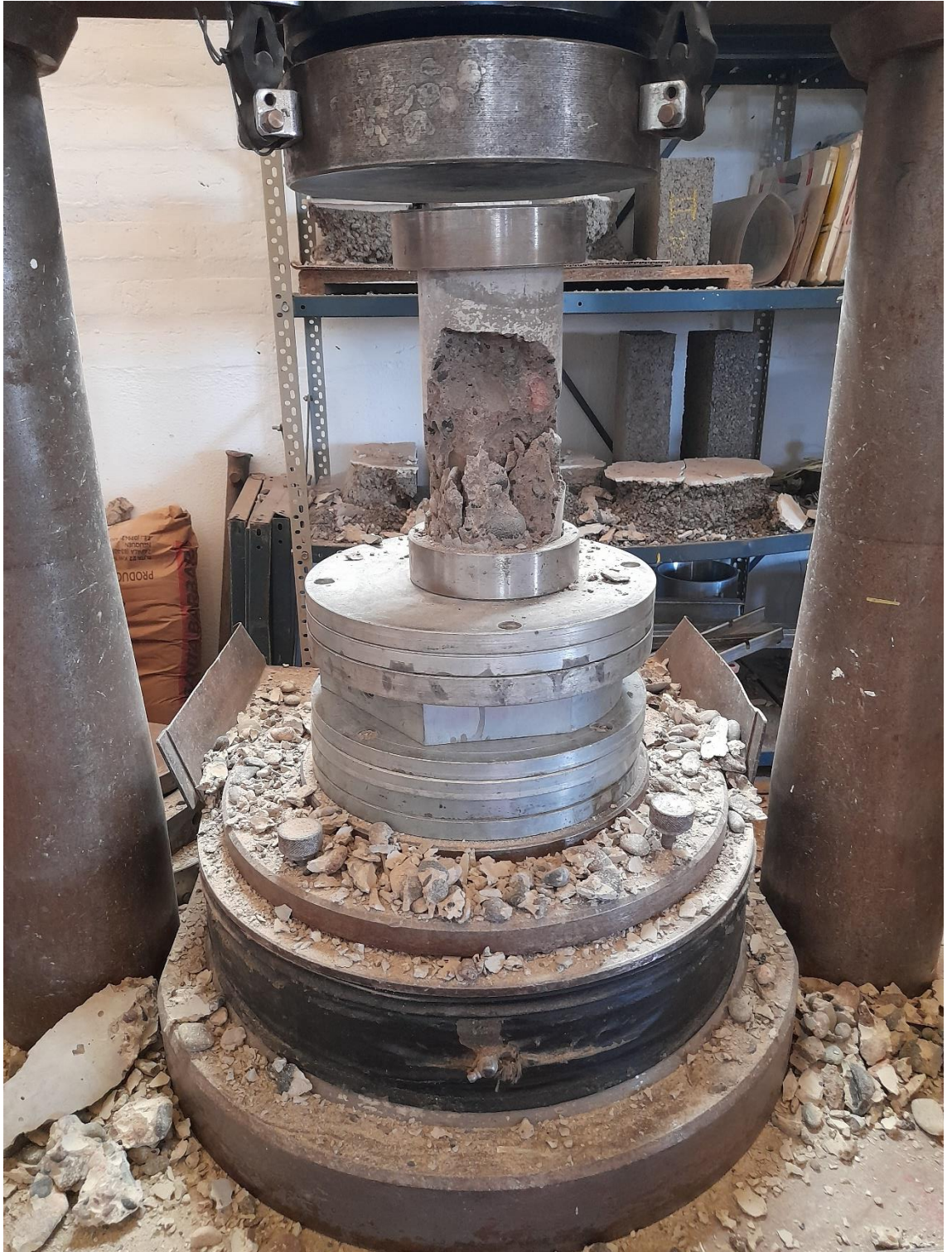
Figura 5: Rotura de la probeta de hormigón al alcanzar la carga de rotura. Foto tomada durante el ensayo de compresión
