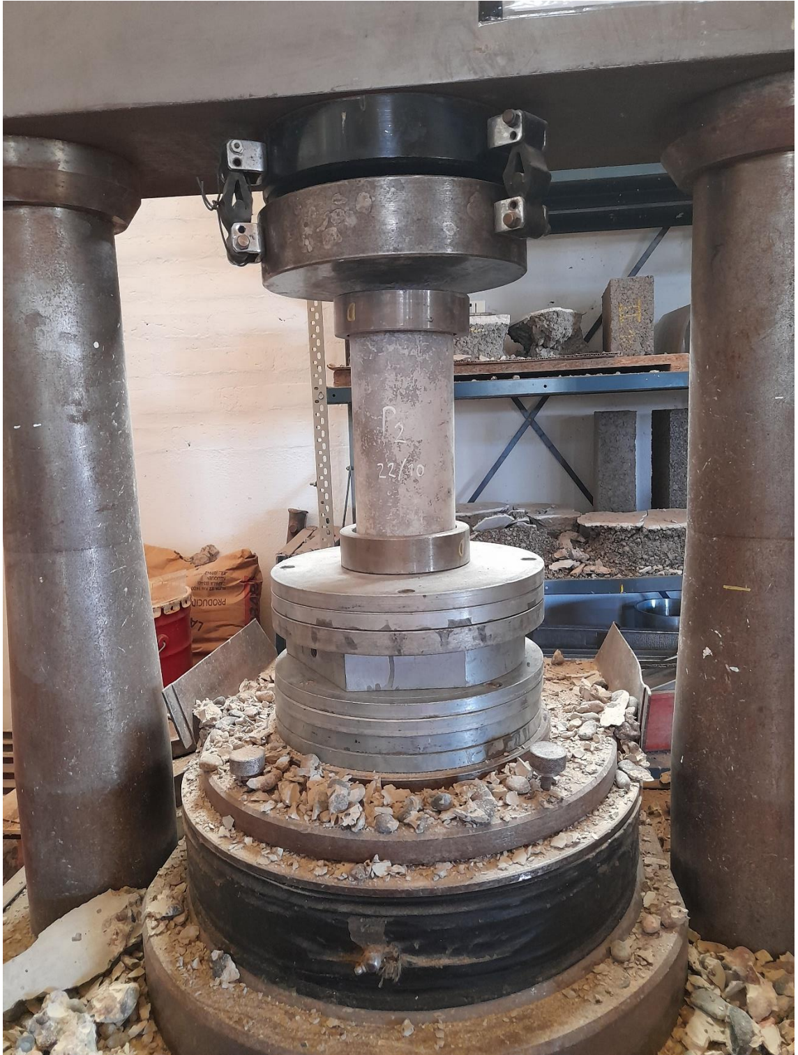
Figura 4: Acondicionamiento de altura mediante discos metálicos. Foto tomada durante el ensayo de compresión.
