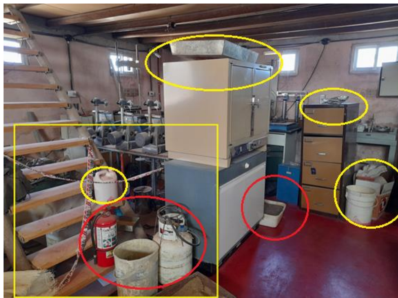
Figura 29: Problemas de Orden y Limpieza en las instalaciones del Laboratorio de Ingeniería Civil
