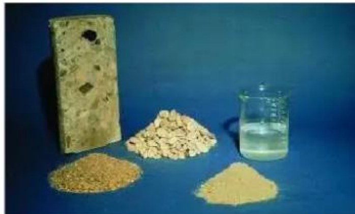
Fig. 1-1. Componentes del concreto: cemento, agua, agregado fino, agregado grueso, son combinados para formar el concreto. (55361)
