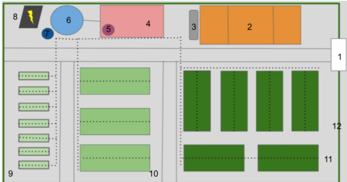
**Figura N°20:** Croquis de distribución de infraestructura del establecimiento. Referencias: 1) Ingreso; 2) Galpón principal; 3) Zeppelin de gas; 4) Galpón secundario; 5) Bomba de riego; 6) Depósito de agua; 7) Bomba de extracción de agua en profundidad; 8) Paneles solares; 9) Sector almácigos; 10) Sector canchas de crías-rápido crecimiento; 11) sector canchas de cría-rustificación; 12) Cerco perimetral-cortina de álamos; Línea punteada: ramales de riego; Línea continua: caminos internos.
