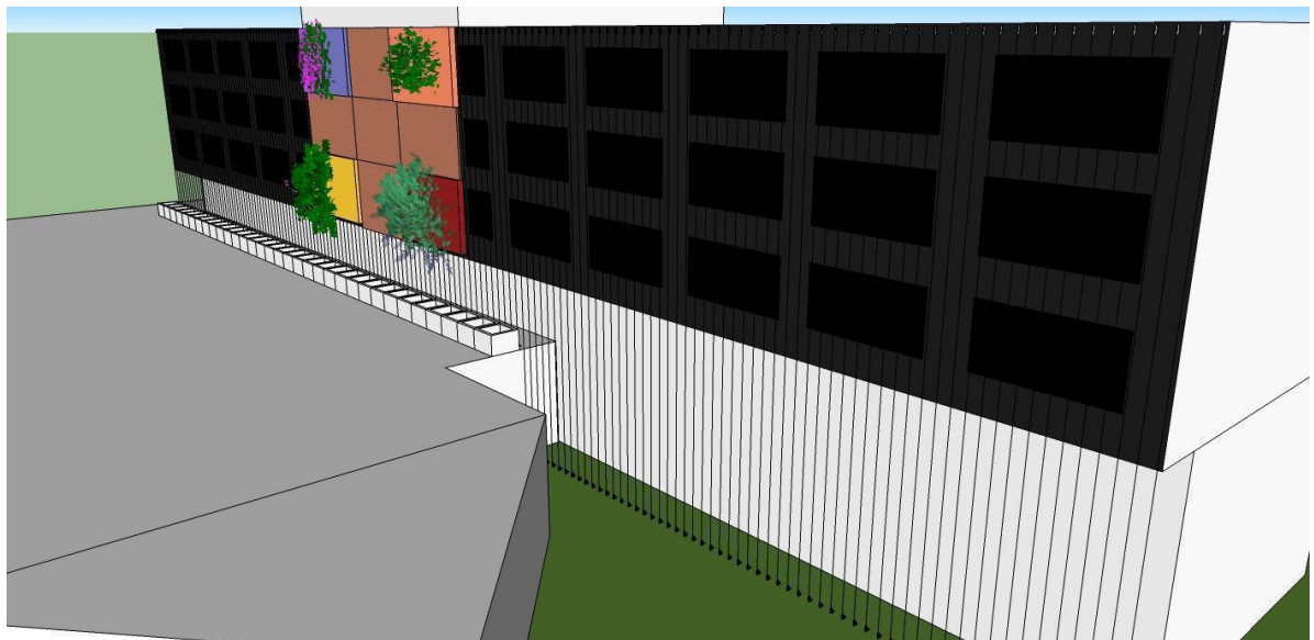
Colocación de tensores en la Etapa 2
