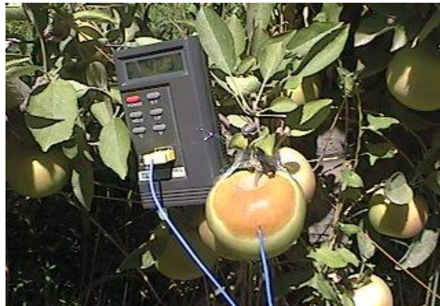
Fotos 5: medición de la temperatura en la cara expuesta a la radiación solar directa en un fruto de manzana variedad de manzana “Braeburn”.
