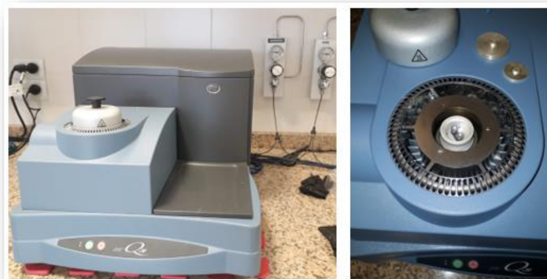
Figura 7: a) Equipo Calorímetro Diferencial de Barrido. b) Celdas de referencia y de la muestra. Empresa Zoxi, Parque Industrial de Nqn.
