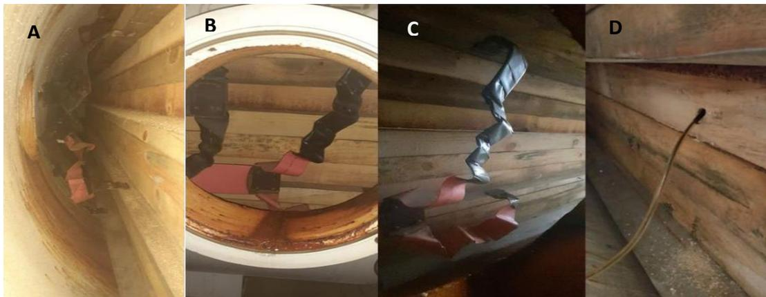
Fig. N° 6. Conexión de cintas positivas (A-B-C) y colocación sensor temperatura (D)
