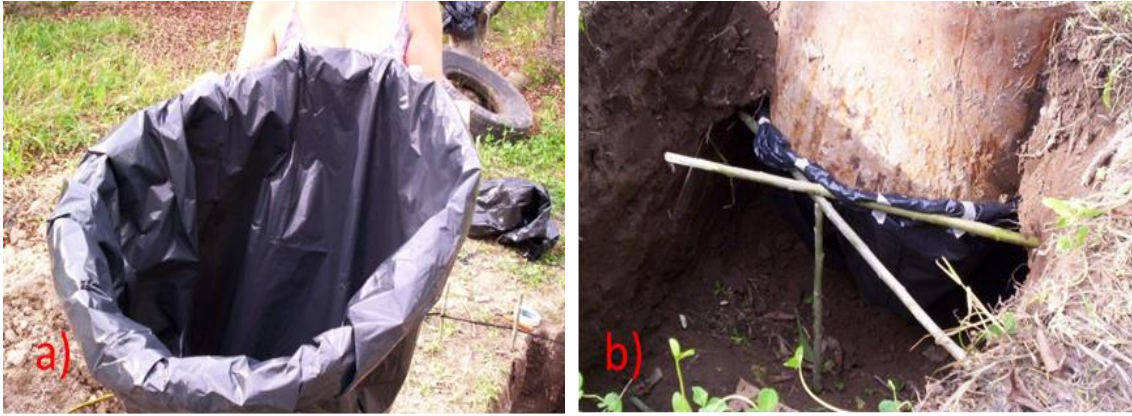
Figura 37. a) Armado de bolsa plástica con diámetro similar al lisímetro; b) Colocación del colector de lixiviados en la parte inferior del lisímetro.
