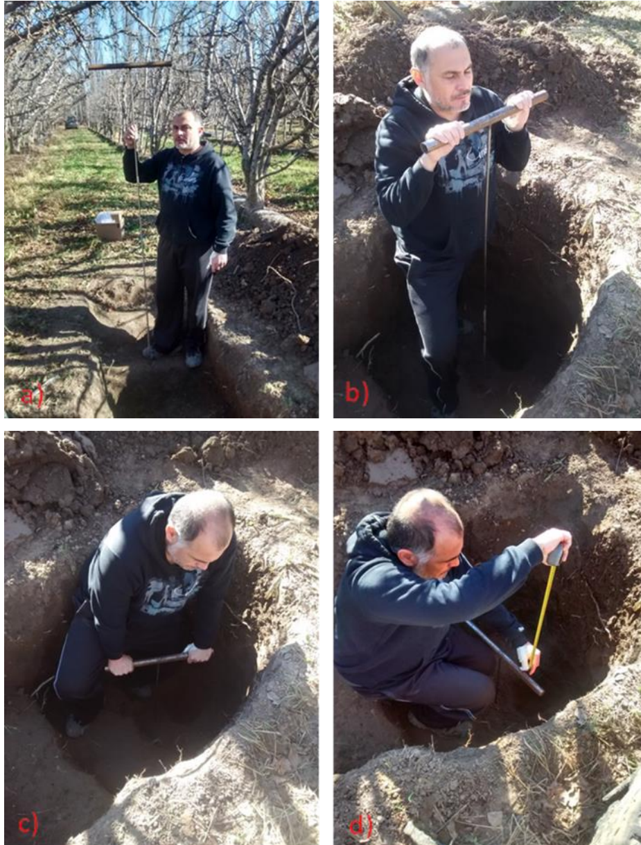
Figura 24. (a) Varilla de hierro acerado en forma de T; (b) Extremo de la varilla apoyada en el fondo de la calicata; (c) Presión en el extremo superior de la varilla; (d) Medición de la capa dura desde la parte superior del terreno.
