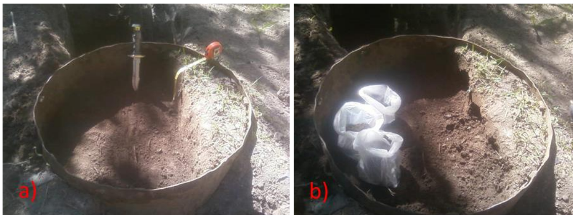
Figura 39. A) Muestreo de suelo en el interior del lisímetro una vez concretado el tratamiento químico y los eventos de riego; b) Recolección de tres repeticiones de suelo por horizonte.
