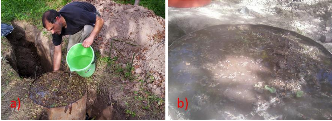
Figura 36. a) Aplicación de un volumen de agua de 30 litros en forma uniforme y controlada b) Lámina de riego de 3 cm de espesor.
