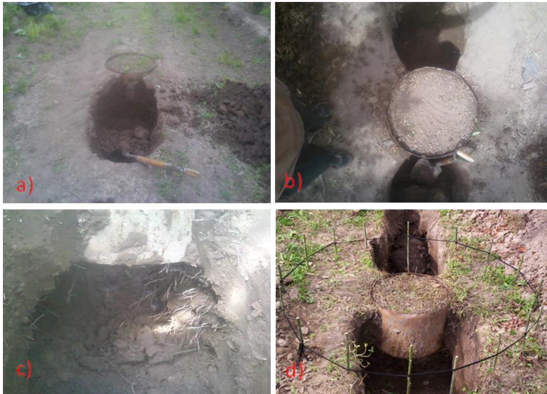
Figura 33. a) Excavación en los laterales del lisímetro; b) Vista frontal con excavación en ambos laterales y porción de suelo sin excavar sosteniendo el lisímetro; c) Excavación parte inferior del lisímetro; d) Excavación finalizada en su parte lateral e inferior.
