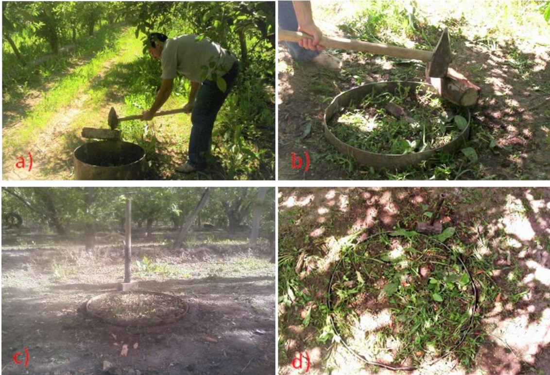
Figura 32. a, b) Golpes de percusión e hincamiento del lisímetro; c) Vista lateral, introducción total del lisímetro; d) Vista frontal, introducción total del lisímetro.
