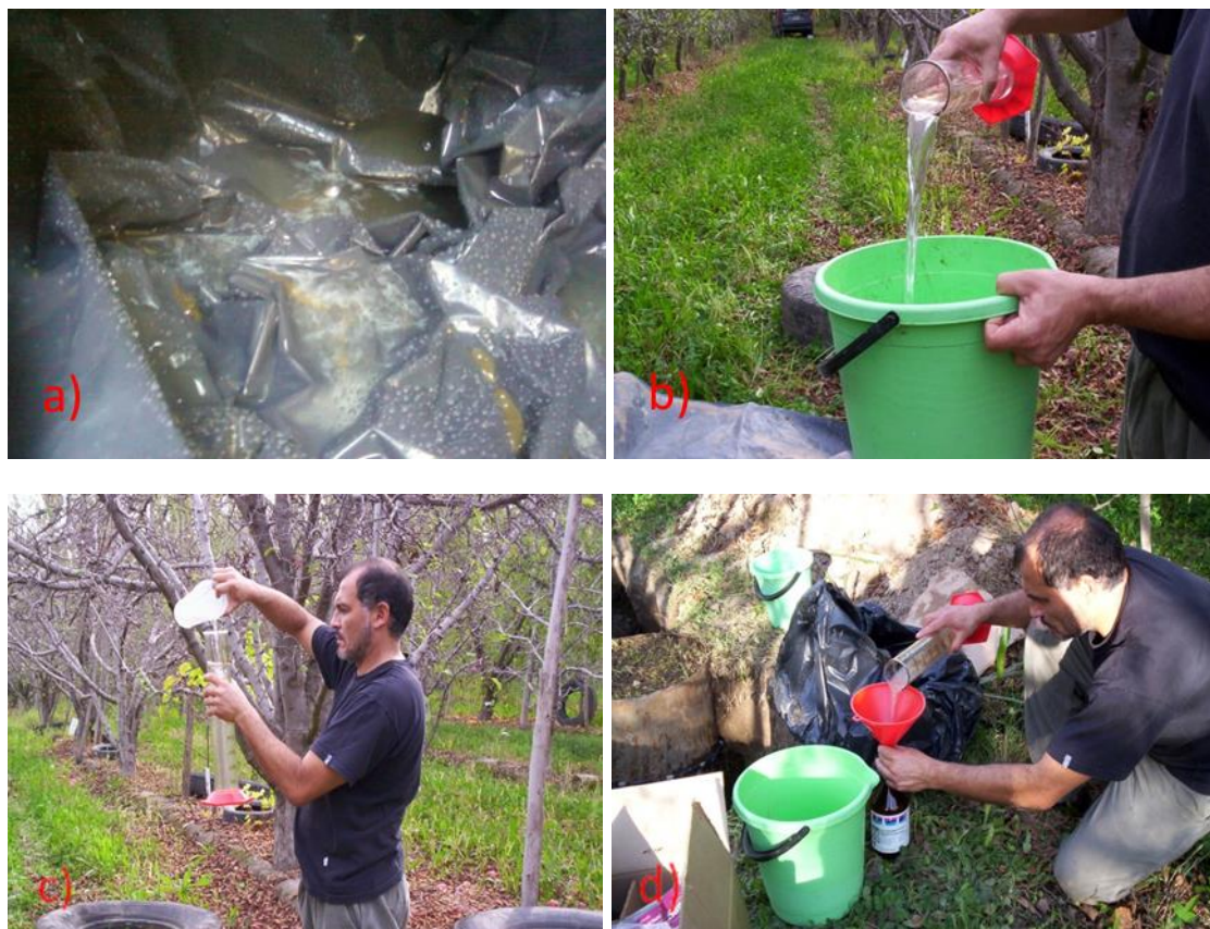
Figura 38. a) Lixiviados interceptados por el colector plástico; b) Medición volumétrica de la muestra lixiviada al cabo de 30 minutos; c) Medición de un volumen mínimo de 2 litros d) Trasvase a botellas de vidrio color caramelo.
