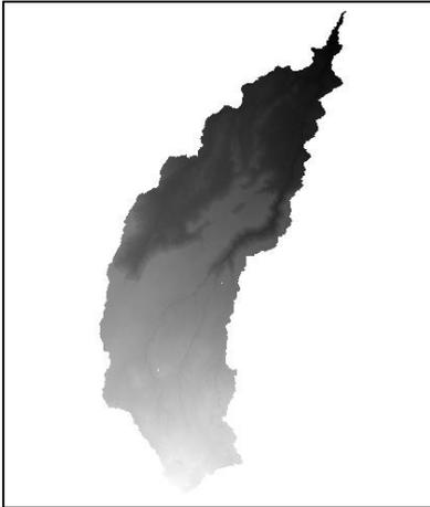
Figura 60: Modelo de elevación digital de la cuenca.
