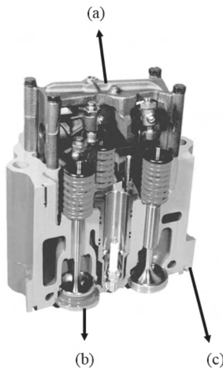
Figura 6. Sistema de distribución (GECó, 2017).
