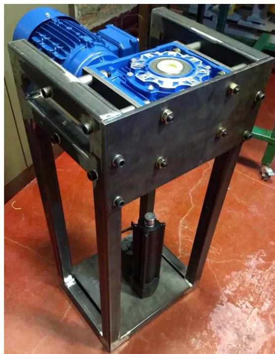
(b) Motor-reductor y actuador lineal
