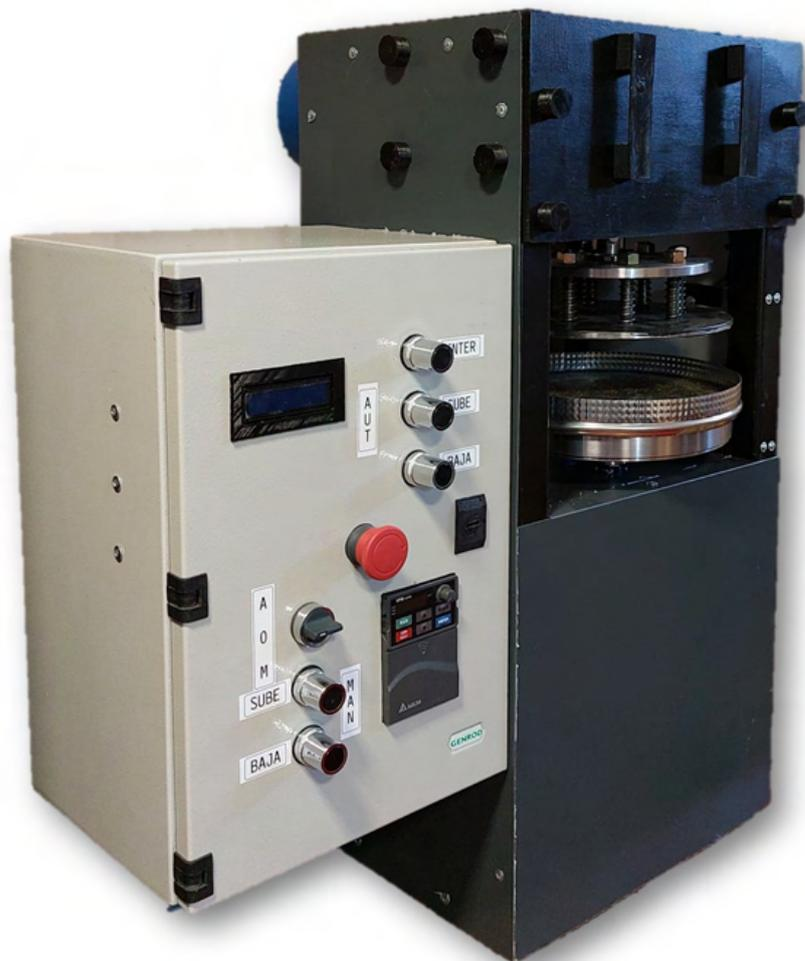
Figura 32. Máquina de escarificación mecánica de semillas de plantas nativas patagónicas.
