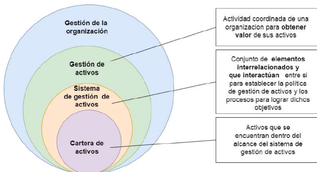
Figura 3. Relación entre los términos clave dados por la Norma ISO 55000 (adaptado de ISO 55000 (2015)).
