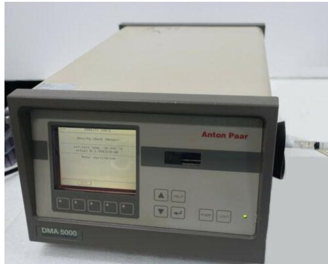
Figura 3.1.2: Densímetro Anton Para DMA 5000
