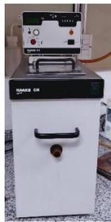
Figura 3.1.6: Baño Termostatizador HAAKE FISIONS 5
