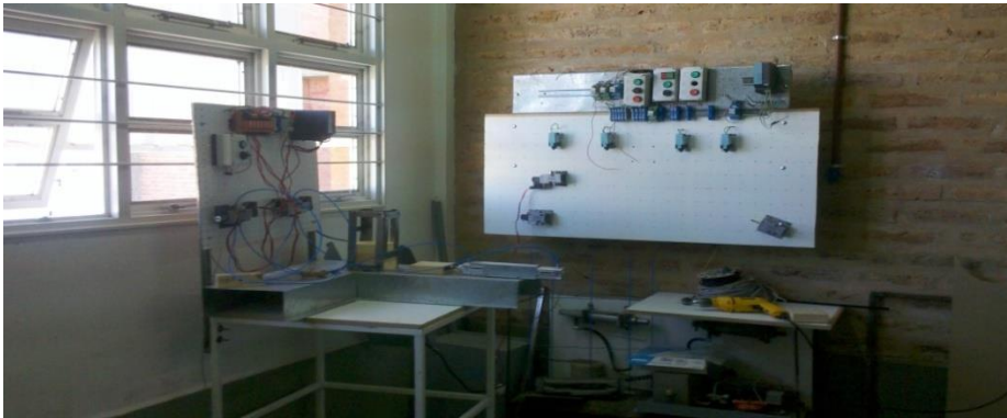
Imagen XI: tablero de neumática
