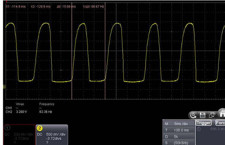
Figura 4.12: Período entre dos pulsos consecutivos de encoder, a máxima velocidad de rotación de un motor.
