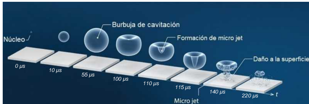
Figura 3.6. Nucleación, crecimiento y colapso de una burbuja. (Science-Journals, https://www.science.org/ )
