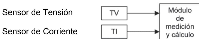
Fig. 2.1 Esquema del instrumento de medición
