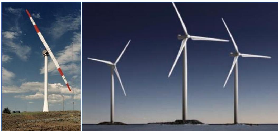
Figura 3.15 – Izquierda: Aerogeneradores de dos palas. (Blog Internet: Naukas, 2010), derecha: Aerogeneradores de tres palas. (ABB Cuaderno Técnico: Plantas Eólicas, 2012)
