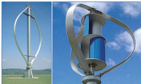
Figura 3.11 – A la izquierda un aerogenerador del tipo Darrieus típico; a la derecha un aerogenerador híbrido Darrieus-Savonius. (ABB Cuaderno Técnico: Plantas Eólicas, 2012)
