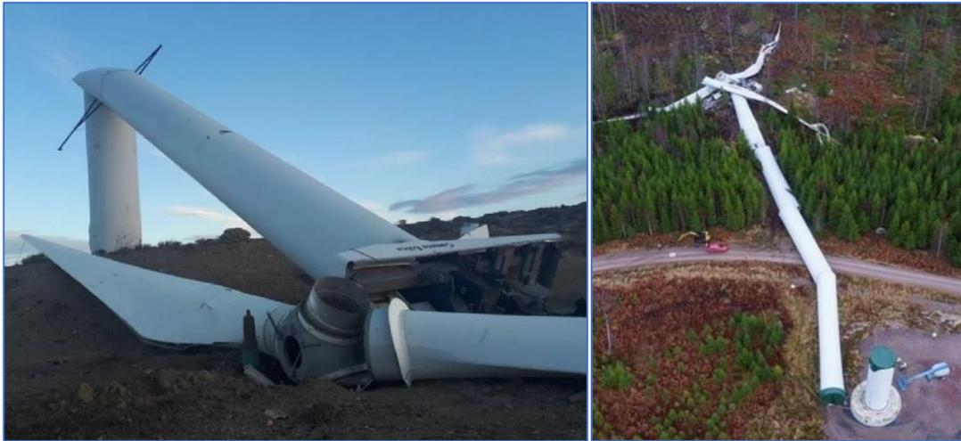
Figura 4.6 – Izquierda: Colapso de aerogenerador en Comodoro Rivadavia (Energía Estratégica, 2020) – Derecha: Colapso de aerogenerador Vestas en Lemhult, Suecia (Swedish Accident Investigation Authority, 2017)
