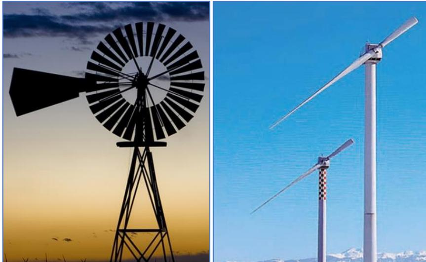
Figura 3.14 – A la izquierda se puede ver un aerogenerador multipala. (Blog Internet: Premium Energía, 2017), a la derecha aerogeneradores monopala. (ABB Cuaderno Técnico: Plantas Eólicas, 2012)
