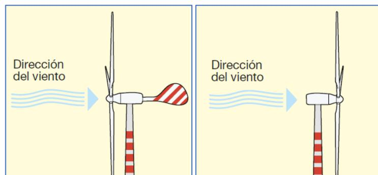
Figura 3.13 – A la izquierda un aerogenerador horizontal a barlovento con aleta direccional; a la derecha un aerogenerador horizontal a sotavento. (ABB Cuaderno Técnico: Plantas Eólicas, 2012)
