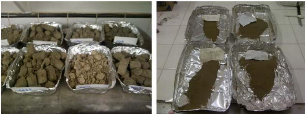
*Figura 10: foto de muestra de suelo seco (izquierda) y tamizado por malla de 2000 micras (derecha).*
