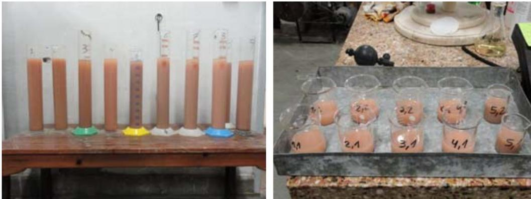
Figura 16: probeta de 1000 mililitros con suelo (izquierda) y alícuota obtenida por pipeta en sus respectivos vasos de precipitado (derecha).
