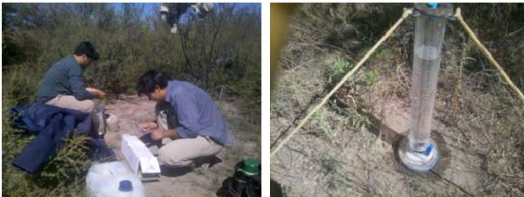
Figura 18: foto del sitio afuera (AF) (izquierda) y del permeámetro de disco (derecha).
