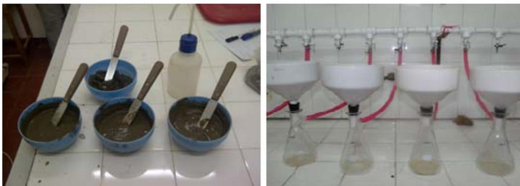
*Figura 11: preparación de pasta de saturación (izquierda) y a la obtención de extracto luego de 24 horas (derecha).*
