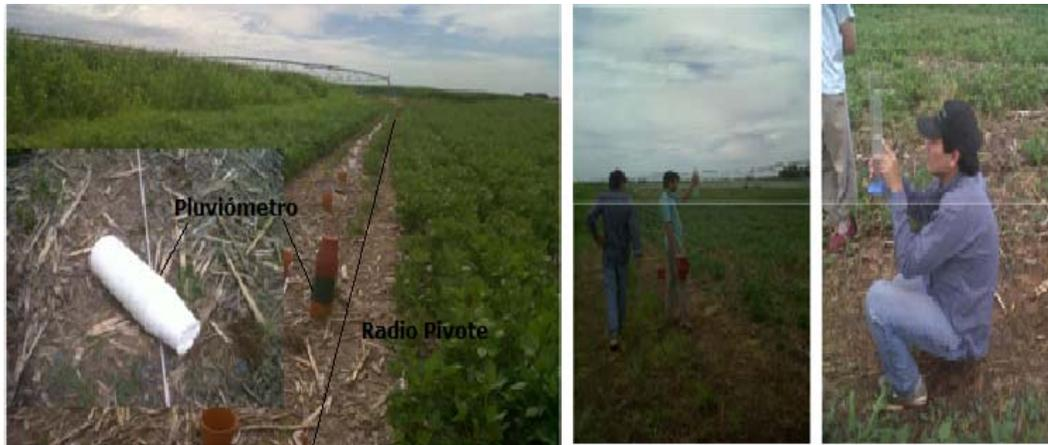
*Figura 7: Foto (izquierda) recipiente de plástico colocado debajo de pivote para el cálculo de la eficiencia de riego, (derecha) medición de los milímetros recogidos en cada maceta por medio de una probeta (Kaitaco marzo 2013).*
