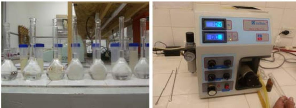
*Figura 14: matraz de 100 mililitros aforado con muestra (izquierda) y medición por el fotometro de llama (derecha).*
