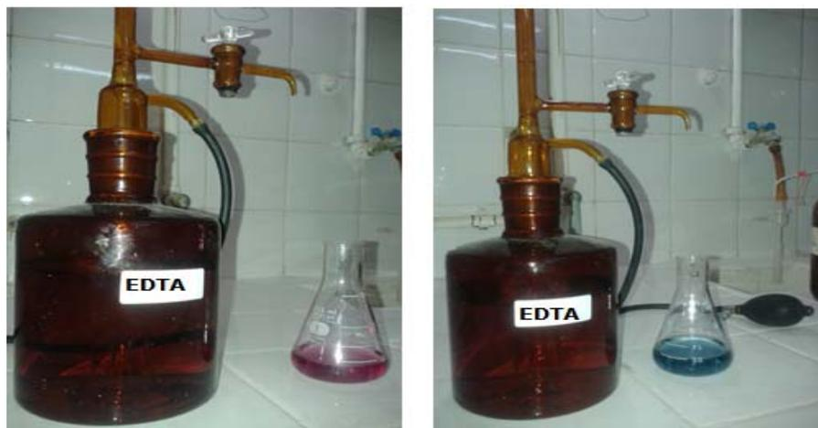
*Figura 15: alicuota del extracto, buffer e indicador (izquierda) y titulación con EDTA hasta el viraje del indicador a azul (derecha).*
