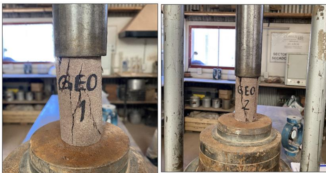
Figura 41: Ensayo de compresión simple para las muestras de roca extraídas.
