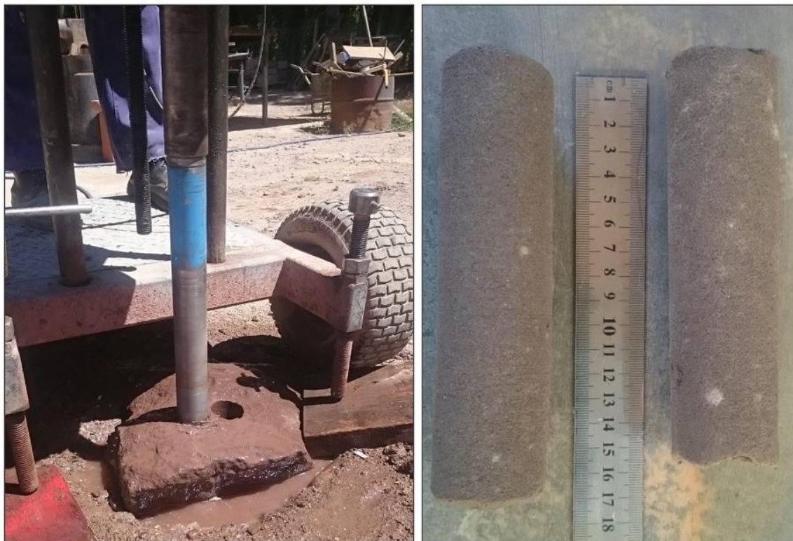
Figura 40: Muestras de roca utilizadas para el ensayo de compresión simple.
