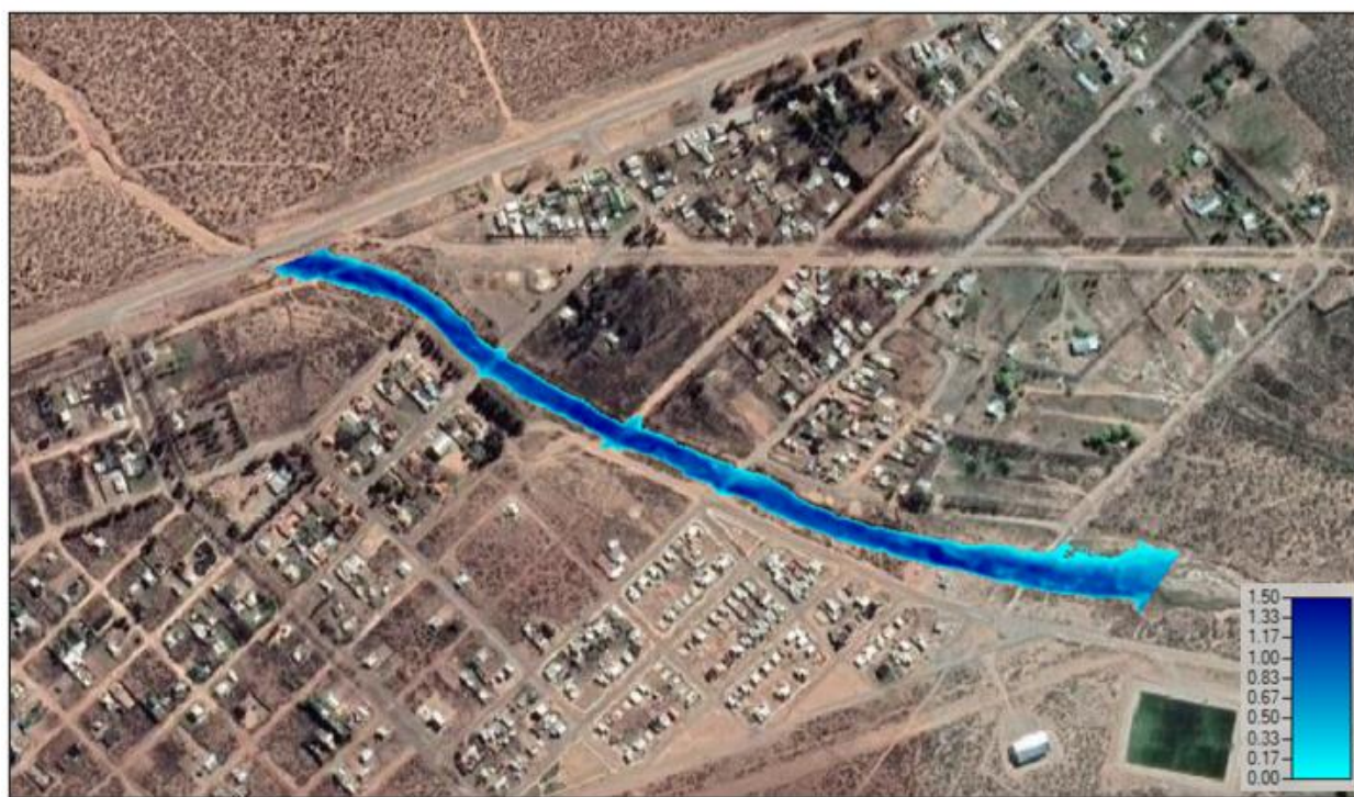
Figura 73: Gráficos de velocidad (arriba) y altura de lámina de escorrentía (abajo) correspondiente al modelo II para tormentas de 100 TR.
