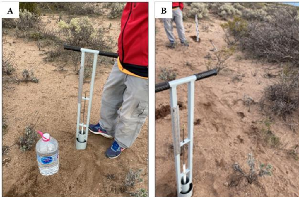
Figura 28: Ensayos de infiltración con anillo doble realizados en los puntos 1 (A) y 4 (B).
