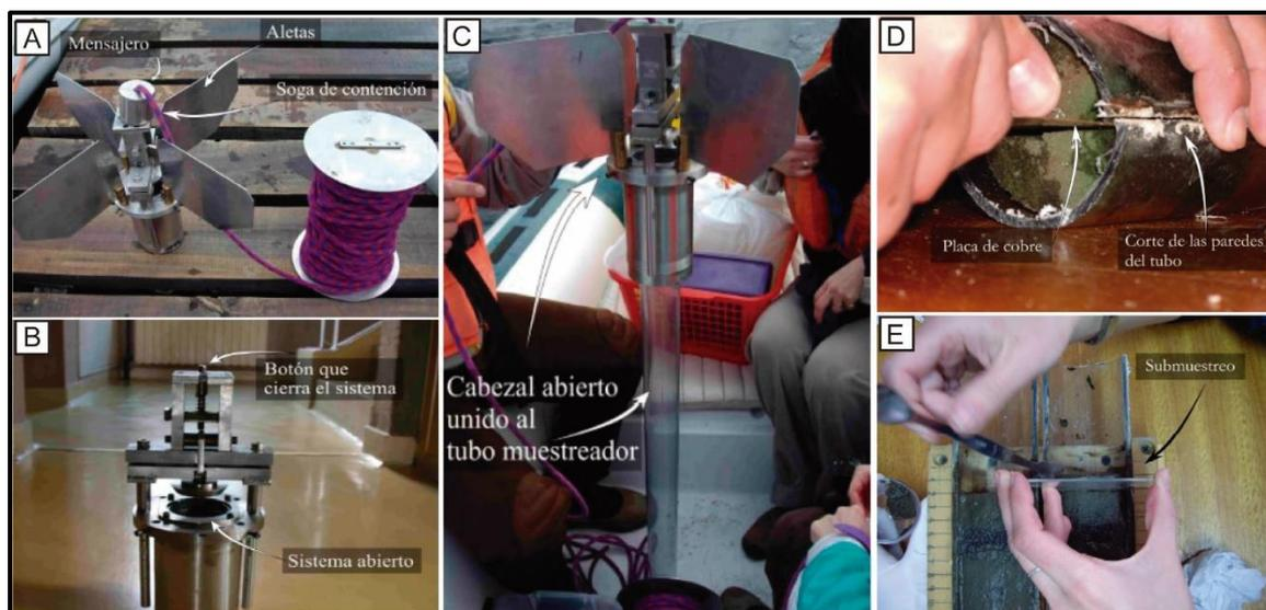
**Figura 10.** A) y B) muestreador de gravedad y sus partes; C) muestreador de gravedad con tubo acrílico listo para sumergir; D) procedimiento de apertura del testigo; E) submuestreo del testigo cada 1 cm.
