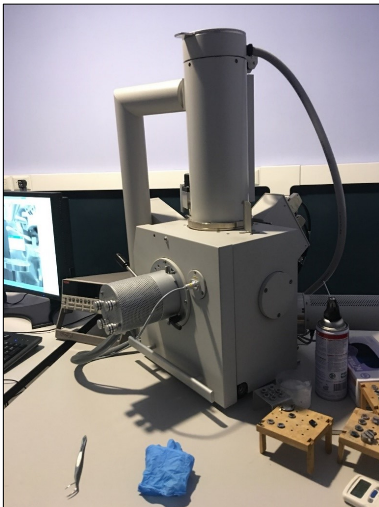
Figura 10: SEM Inspect S50, (Departamento de Caracterización de Materiales, Centro Atómico Bariloche).
