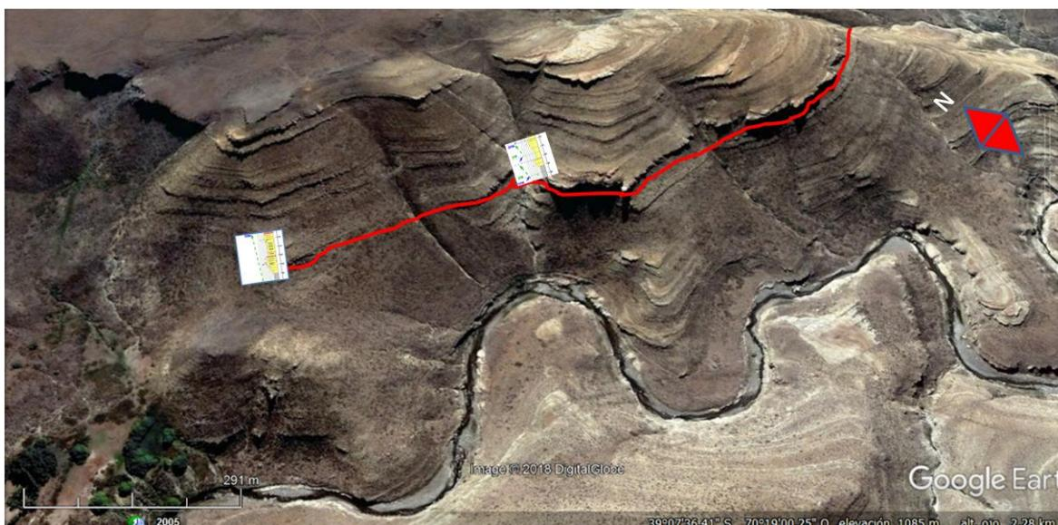
*Figura 46: Foto satelital del afloramiento. Imágenes superpuestas: limoarcilitas utilizadas como amarre estratigráfico marcadas con línea roja (a la izquierda perfil 2 y a la derecha perfil 1). Puede notarse que su correlación es de varios cientos de metros*
