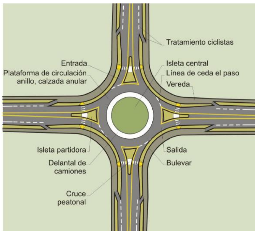
Figura 5.2 – Elementos que forman parte de una Rotonda Moderna.
