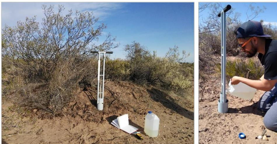
**Figura 12:** Infiltrómetro de 5 cm de diámetro interno, utilizado para la estimación de la tasa de infiltración.
