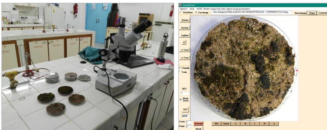
Figura 9: Microscopio estereoscópico utilizado para observación de las submuestras. Imagen de submuestra en la interfaz del programa SamplePoint.
