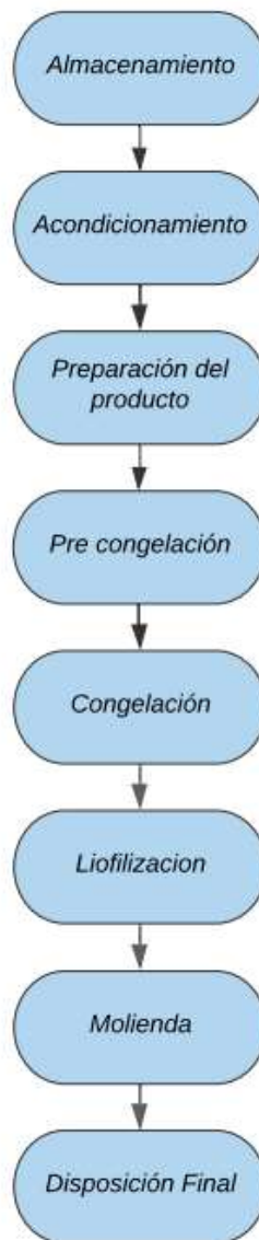
Figura 43. Diagrama de flujo de la propuesta del proceso.
