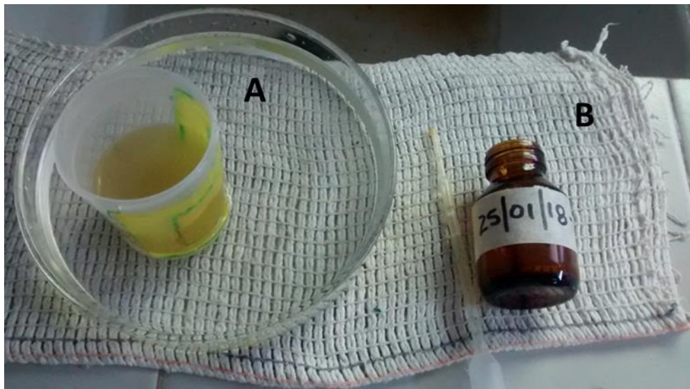
Fig 3. Elementos para concentrar las muestras: A) Vaso plástico con ventana para filtrar con una malla de 20 \mu\text{m} . B) Frasco de 40 ml.
