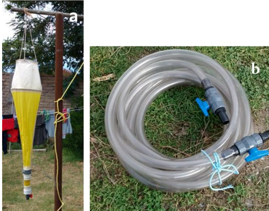
Fig 2. Elementos de muestreo: a) Red bicónica con tamaño de poro de 20 \mu\text{m} . b) Manguera
