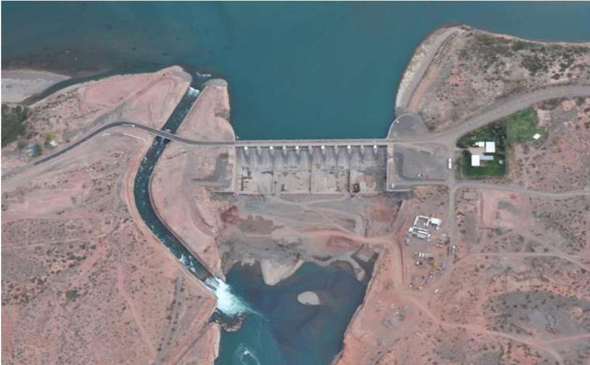
*Figura I-10 - Canal derivador en funcionamiento.*
